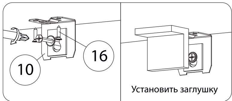
Опрокидывание мебели может привести к серьёзным телесным повреждениям. Рекомендуем зафиксировать изделие к стене при помощи мебельного навеса(9) для предотвращения его опрокидывания. Материалы стен различаются, поэтому крепежные средства не прилагаются. Используйте крепежные средства, подходящие для материала стен в Вашем доме. Для выбора крепежных средств обратитесь в специализированный магазин.
