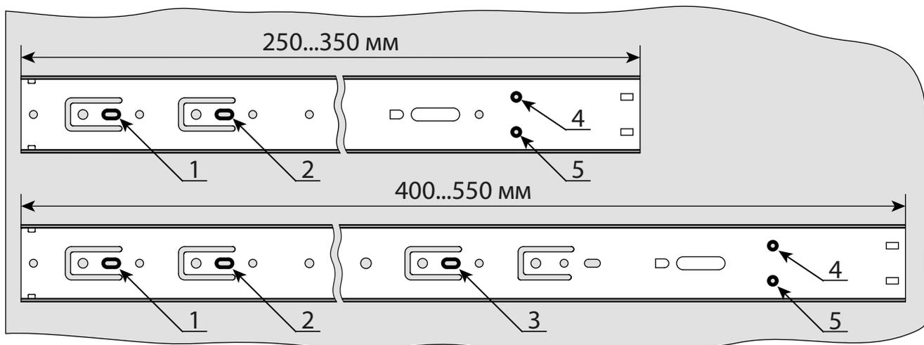
Если направляющие крепятся с двух сторон на одном уровне на одной вертикали, то возможно пересечение крепежа, что может привести к невозможности корректной установки. Для предотвращения этого овальные отверстия (1) на одной из направляющих необходимо совместить с наметками на вертикали, и закрепить в круглые отверстия (2) направляющей.
