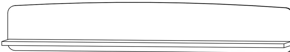
С помощью линейки и карандаша на стене отмечаем место, где будет крепиться полка. Отдельно намечаем места, где надо сверлить отверстия под крепления. Просверливаем три отверстия в стене при помощи дрели. Молотком загоняем дюбеля в отверстия. В дюбеля забиваем гвозди. Вешаем полку.
