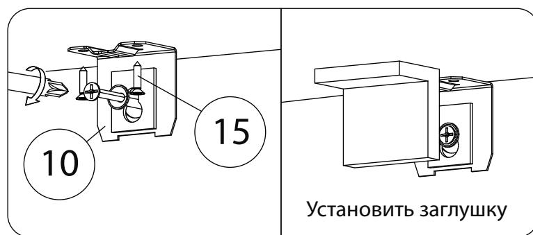
Опрокидывание мебели может привести к серьёзным телесным повреждениям. Рекомендуем зафиксировать изделие к стене при помощи мебельного навеса (10) для предотвращения его опрокидывания. Материалы стен различаются, поэтому крепежные средства не прилагаются. Используйте крепежные средства, подходящие для материала стен в Вашем доме. Для выбора крепежных средств обратитесь в специализированный магазин.
