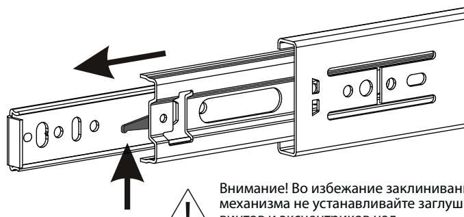
Схема установки шариковых направляющих.
