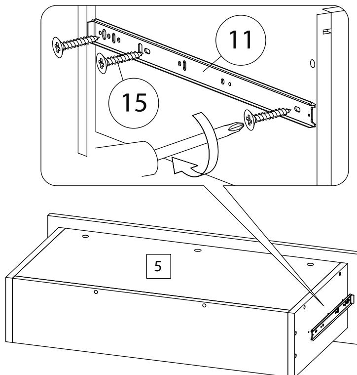
В отдельных случаях, наметки для направляющих могут не совпадать. В этом случае, нужно придерживаться горизонтали, на которой уже есть наметки и установить направляющие вручную.
