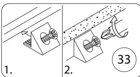
В отдельных случаях, наметки для направляющих могут не совпадать. В этом случае, нужно придерживаться горизонтали, на которой уже есть наметки и установить направляющие вручную вплотную к фасаду ящика.
