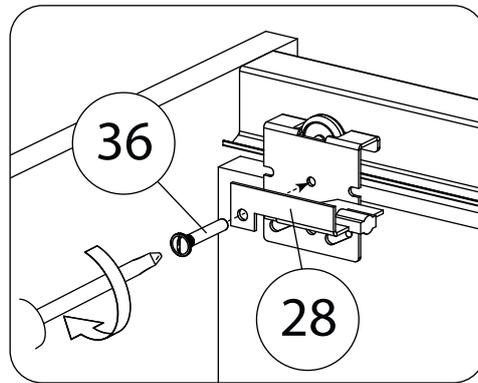
После навеса дверей, в закрытом положении, над крайними роликами правой и левой двери установить позиционеры (30) для фиксации дверей. Во избежание удара ручек о торец дверей необходимо установить на крайний ролик задней двери стопор с амортизатором (28).
