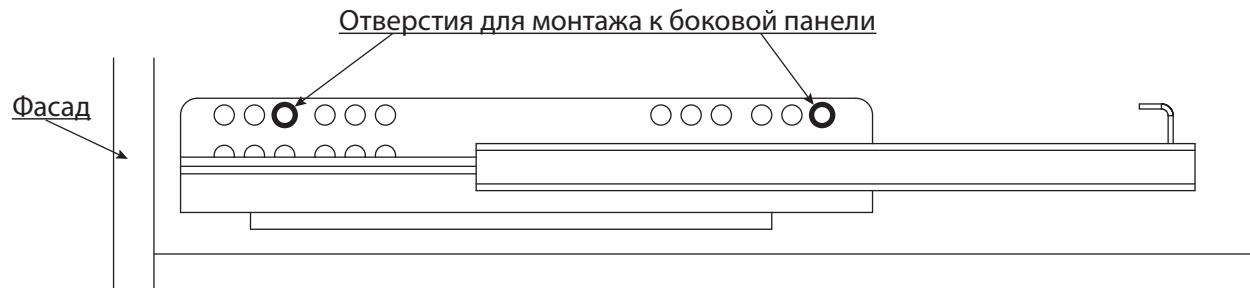
Если направляющие крепятся на одной боковине с 2-х сторон, то саморезы необходимо крепить в разные отверстия направляющей.
