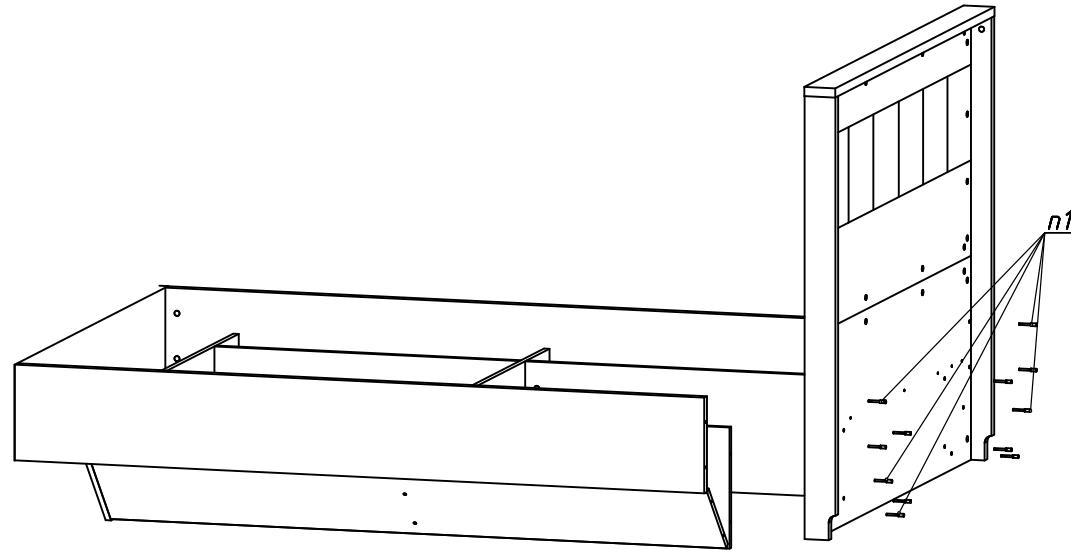
**4.4.** Закройте головки евровинтов (поз.1) и эксцентриков (поз.5) декоративными заглушками (поз.7) и (поз.8)
