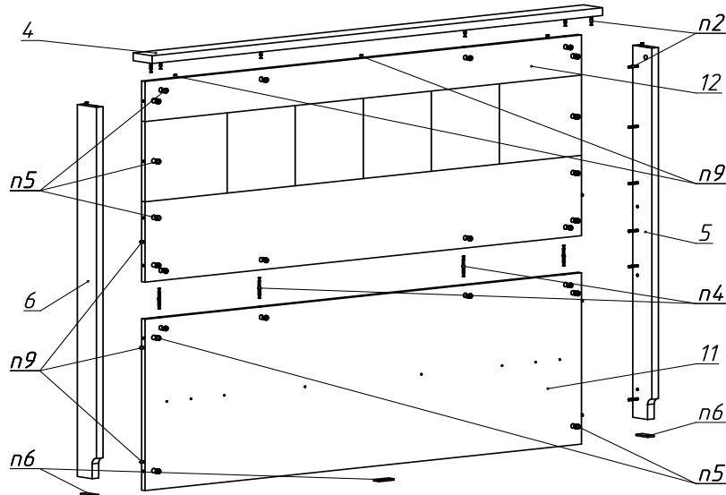
**4.2.** Установите на детали кровати шканты (поз.9), штоки эксцентриков (поз.2) и подпятники (поз.6). Соедините среднюю опору (дет.№7) и продольные опоры (дет.9) с помощью 2-х сторонних штоков (поз.3) и эксцентриков (поз.5). Евровинтами (поз.1) прикрепите опору (дет.№8) и панели (дет.№10). Установите и закрепите эксцентриками (поз.5), боковые царги (дет.№1 и №2) и переднюю царгу (дет.№3)
