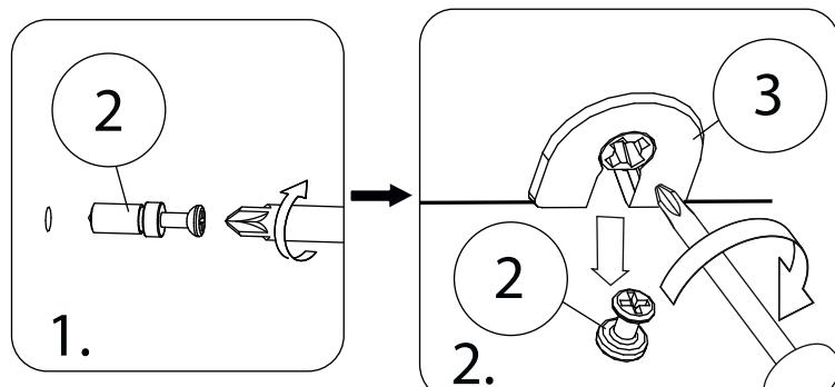
При установке блока ящиков в низ проёма шкафа , его необходимо привернуть изнутри к шкафу саморезами 3,5x30 (29).
