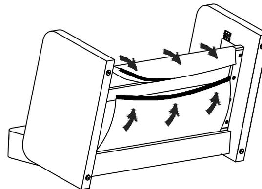
Снять защитную полосу с контактной ленты.
