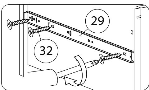
В отдельных случаях, наметки для направляющих могут не совпадать. В этом случае, нужно придерживаться горизонтали, на которой уже есть наметки и установить направляющие вручную.
