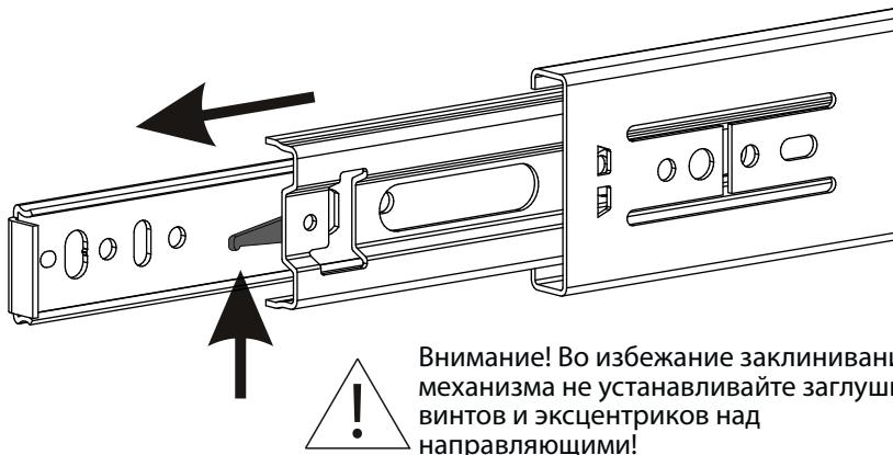
Схема установки шариковых направляющих.
