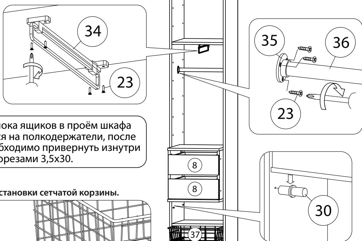
Схема установки сетчатой корзины.
