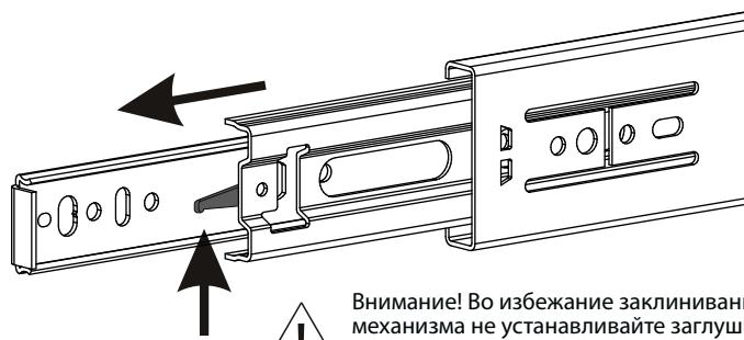
Схема установки шариковых направляющих.
