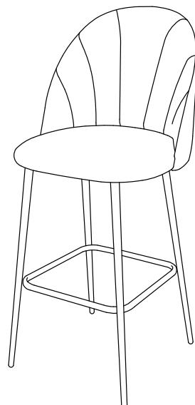
После сборки изделия допускается отклонение от плоскостности 4 ножек до 1,5 мм, которое нивелируется в процессе эксплуатации
