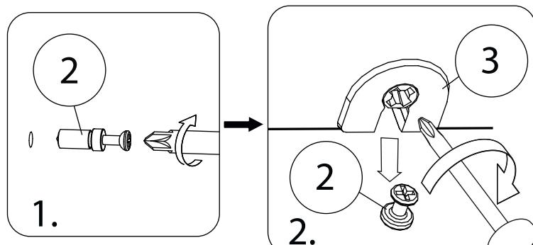
При установке блока ящиков в низ проёма шкафа , его необходимо привернуть изнутри к шкафу саморезами 3,5x30 (14).
