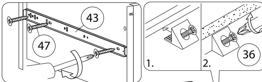
В отдельных случаях, наметки для направляющих могут не совпадать. В этом случае, нужно придерживаться горизонтали, на которой уже есть наметки и установить направляющие вручную.
