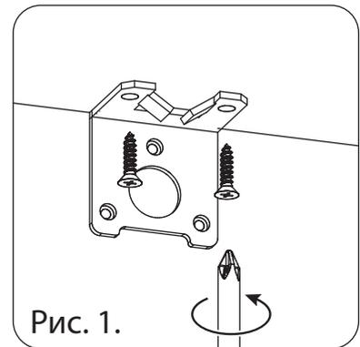
2. Сделайте технологическое отверстие  $\varnothing$  6-10 мм в задней стенке по центру большого отверстия мебельного навеса, чтобы через него закрепить изделие к стене.
