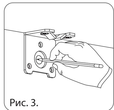
4. Отодвиньте изделие и сделайте в стене крепёжное отверстие под дюбель по разметке. Диаметр и глубина этого отверстия должны соответствовать выбранным Вами крепежным средствам.
