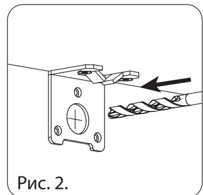
3. Разместите изделие в том месте комнаты, где оно будет постоянно находиться. Придвиньте изделие вплотную к стене, следя за тем, чтобы изделие полностью опиралось на пол. Через технологическое отверстие в задней стенке сделайте карандашом на стене разметку осевых линий крепёжного отверстия под дюбель.
