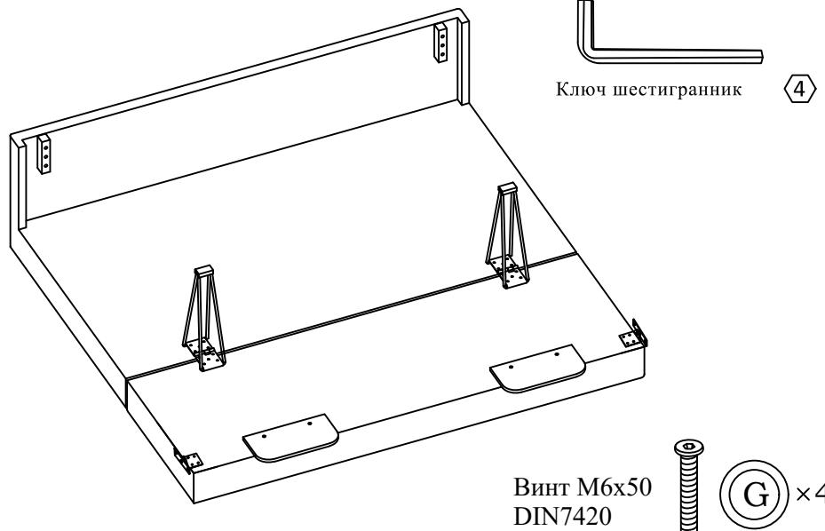
4.2 На фабрике в царгу установлены проставки для опор (деревянные бруски). В них вкручено по три винта. Необходимо выкрутить по два верхних винта. Третий (нижние) винты НЕ выкручивать! (выкрученные винты утилизировать)
