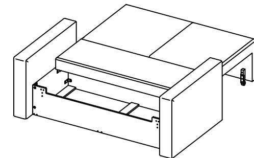
Закрепить механизм слева и механизм справа.
