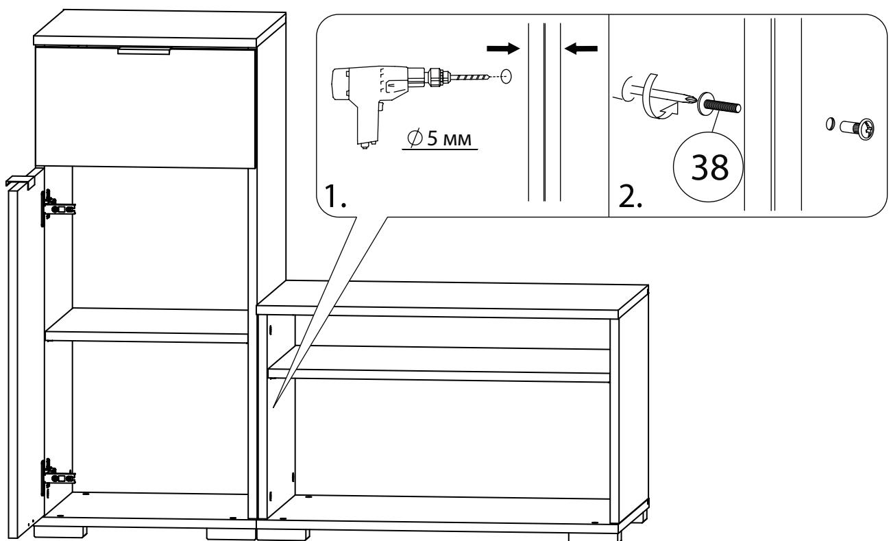
Модули между собой стягиваются межсекционными стяжками. Под которые предварительно просверливаются сквозные отверстия в боковинах, диаметром 5мм..
