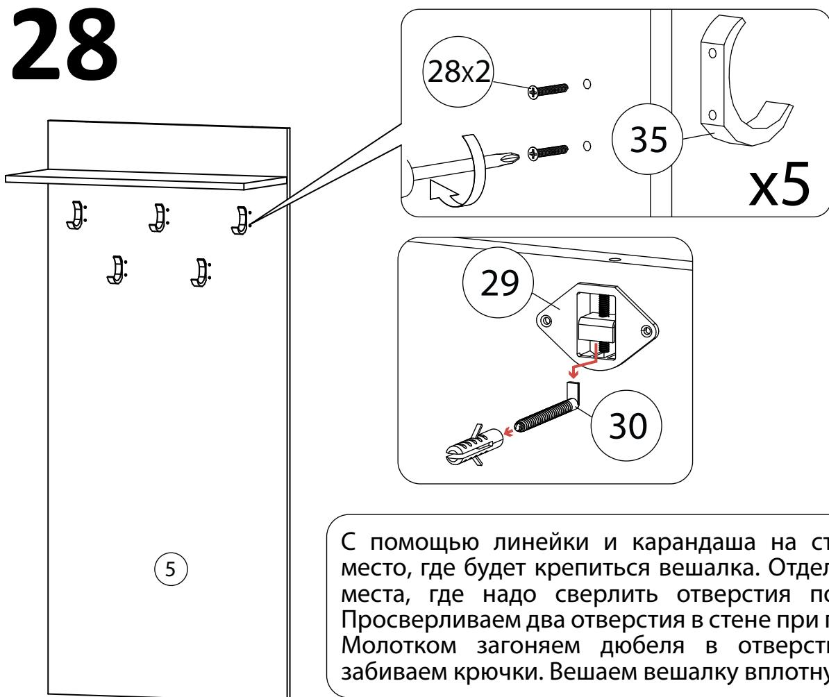
С помощью линейки и карандаша на стене отмечаем место, где будет крепиться вешалка. Отдельно намечаем места, где надо сверлить отверстия под крепления. Просверливаем два отверстия в стене при помощи дреили. Молотком загоняем дюбеля в отверстия. В дюбеля забиваем крючки. Вешаем вешалку вплотную к зеркалу.
