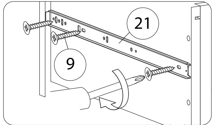
В отдельных случаях, наметки для направляющих могут не совпадать. В этом случае, нужно придерживаться горизонтали, на которой уже есть наметки и установить направляющие вручную.
