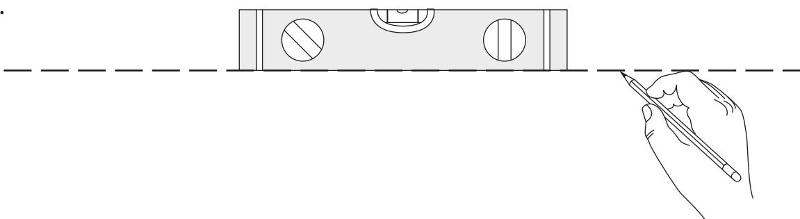
При помощи карандаша и рулетки (длинной линейки) разметьте центра отверстий с необходимыми отступами от краёв.
