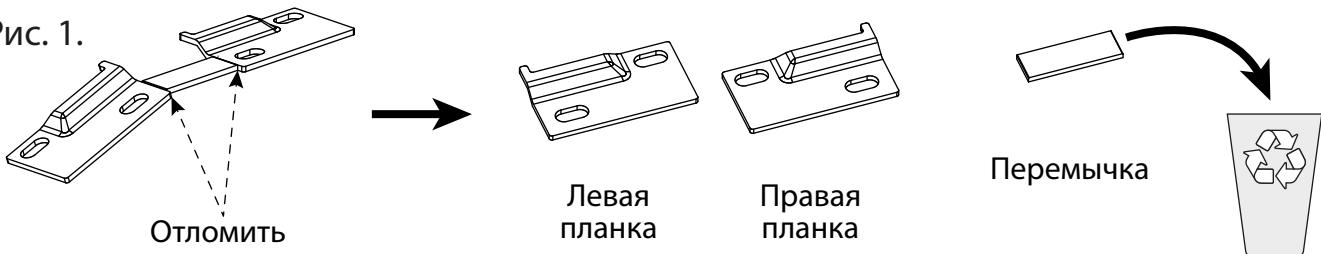
Закрепите планки для подвесов на стене в подготовленные отверстия (см. рис. 2). Для того, чтобы боковина корпуса на упиралась в планку для подвесов и чтобы плотно прижать изделие к стене, необходимо планку для подвеса крепить на расстоянии не менее 4 мм от внутренней поверхности боковины корпуса.
