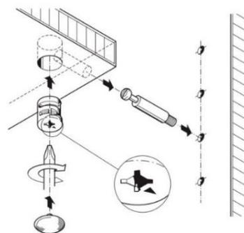
В комплекте заложена стяжка (Φ-8) для крепления одного модуля с другим при необходимости. Для установки стяжки просверлить отверстия Ø5-7 мм в местах крепления, подложив брусок в месте выхода сверла во избежание «вырыва» материала.
