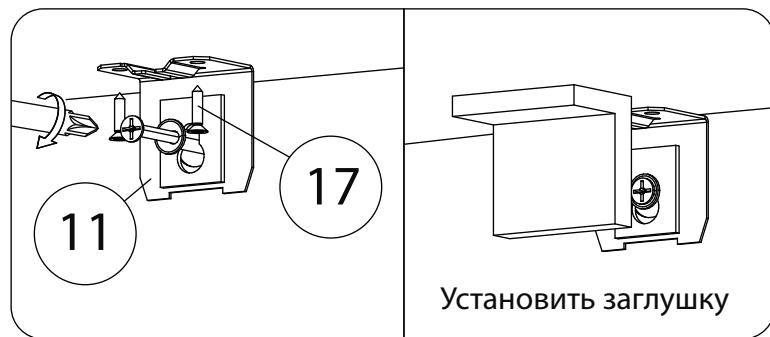
Опрокидывание мебели может привести к серьёзным телесным повреждениям. Рекомендуем зафиксировать изделие к стене при помощи мебельного навеса (11) для предотвращения его опрокидывания. Материалы стен различаются, поэтому крепежные средства не прилагаются. Используйте крепежные средства, подходящие для материала стен в Вашем доме. Для выбора крепежных средств обратитесь в специализированный магазин.
