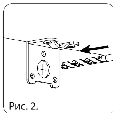
3. Разместите изделие в том месте комнаты, где оно будет постоянно находиться. Придвиньте изделие вплотную к стене, следя за тем, чтобы изделие полностью опиралось на пол. Через технологическое отверстие в задней стенке сделайте карандашом на стене разметку осевых линий крепёжного отверстия под дюбель.
