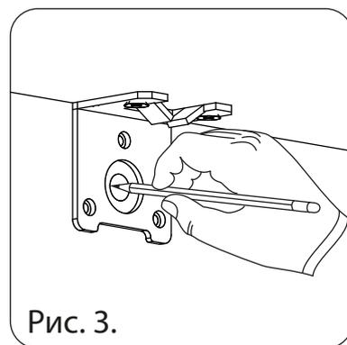
4. Отодвиньте изделие и сделайте в стене крепёжное отверстие под дюбель по разметке. Диаметр и глубина этого отверстия должны соответствовать выбранным Вами крепежным средствам.
