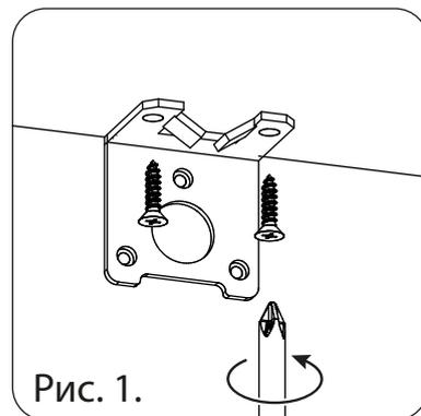
2. Сделайте технологическое отверстие  $\varnothing$  6-10 мм в задней стенке по центру большого отверстия мебельного навеса, чтобы через него закрепить изделие к стене.
