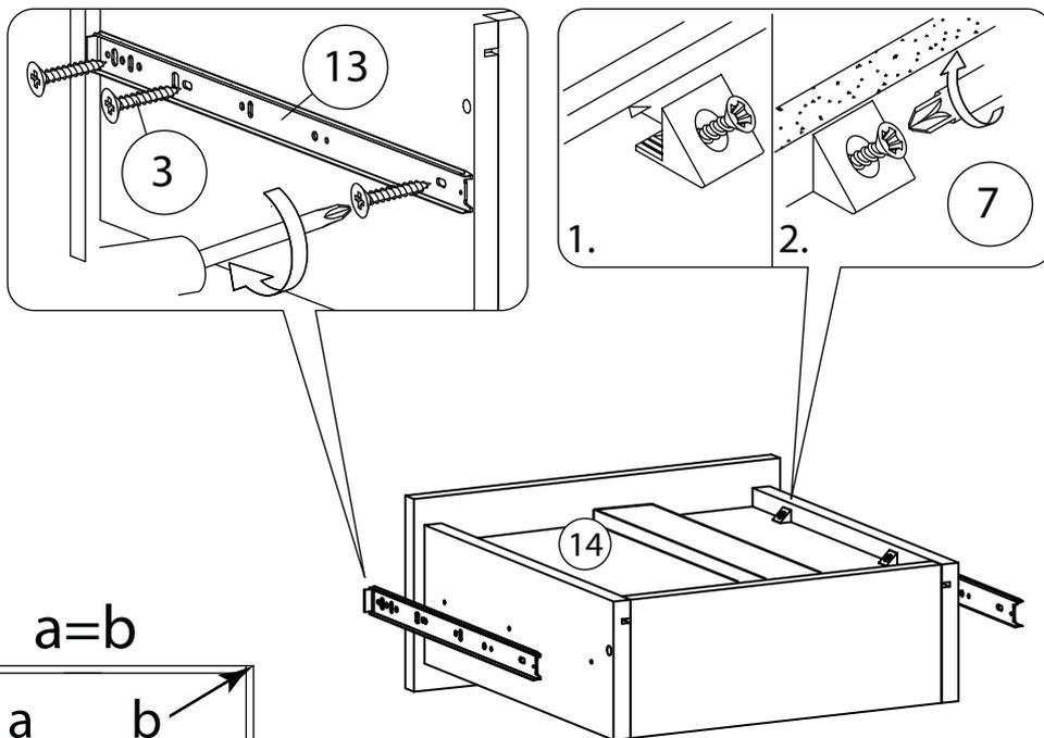
В отдельных случаях, наметки для направляющих могут не совпадать. В этом случае, нужно придерживаться горизонтали, на которой уже есть наметки и установить направляющие вручную.
