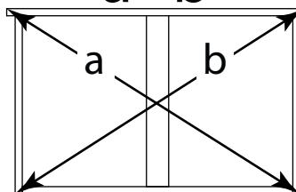
В отдельных случаях, наметки для направляющих могут не совпадать. В этом случае, нужно придерживаться горизонтали, на которой уже есть наметки и установить направляющие вручную.
