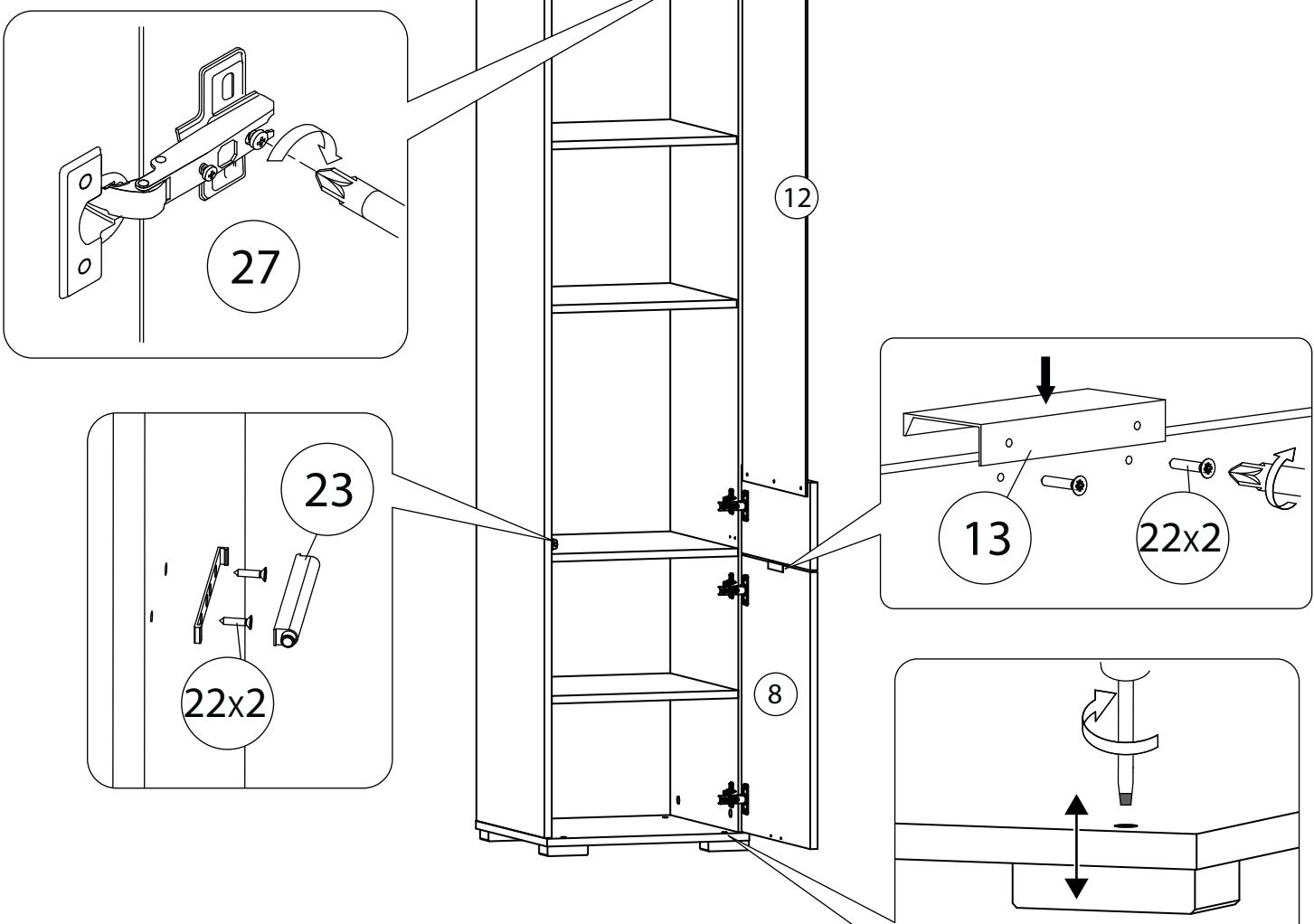
Регулировка опоры по высоте
