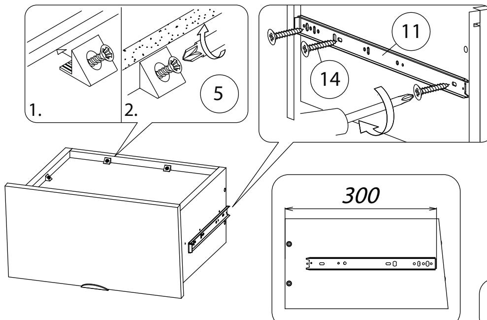
В отдельных случаях, наметки для направляющих могут не совпадать. В этом случае, нужно придерживаться горизонтали, на которой уже есть наметки и установить направляющие вручную.
