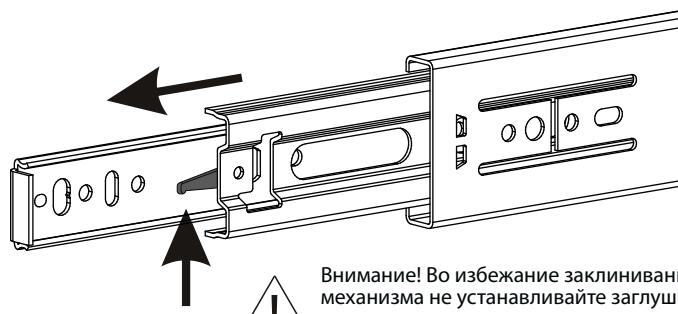
Схема установки шариковых направляющих.
