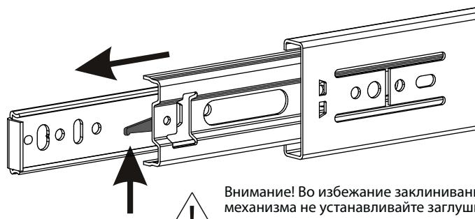
Схема установки шариковых направляющих.
