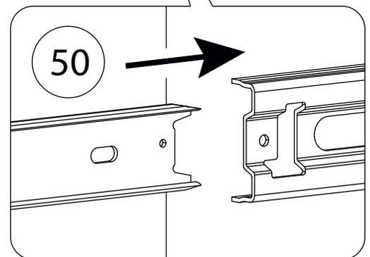
В том случае, если направляющие ящика(50) работают туго возможен вариант снятия резинок с направляющих для улучшения хода.
