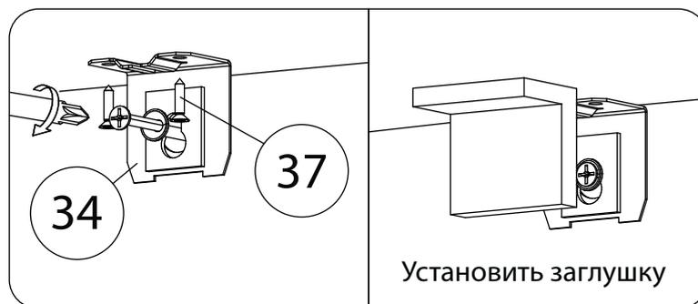
Опрокидывание мебели может привести к серьёзным телесным повреждениям. Рекомендуем зафиксировать изделие к стене при помощи мебельного навеса(34) для предотвращения его опрокидывания. Материалы стен различаются, поэтому крепежные средства не прилагаются. Используйте крепежные средства, подходящие для материала стен в Вашем доме. Для выбора крепежных средств обратитесь в специализированный магазин.
